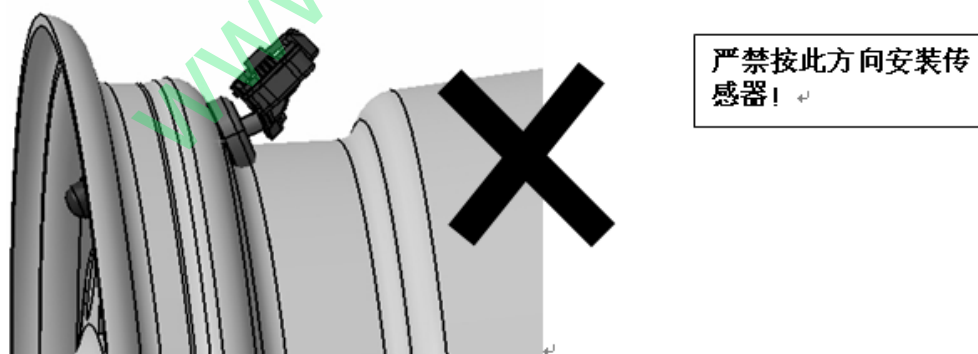
图 1.9 错误安装方向放大效果图
